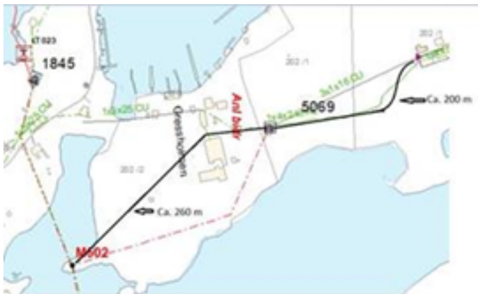
Figur 1: Den sorte heltrukne linjen viser grøften for høyspent fra hangaren til trafo 5069. Rød stiplestrek er dagens luftspenn.
